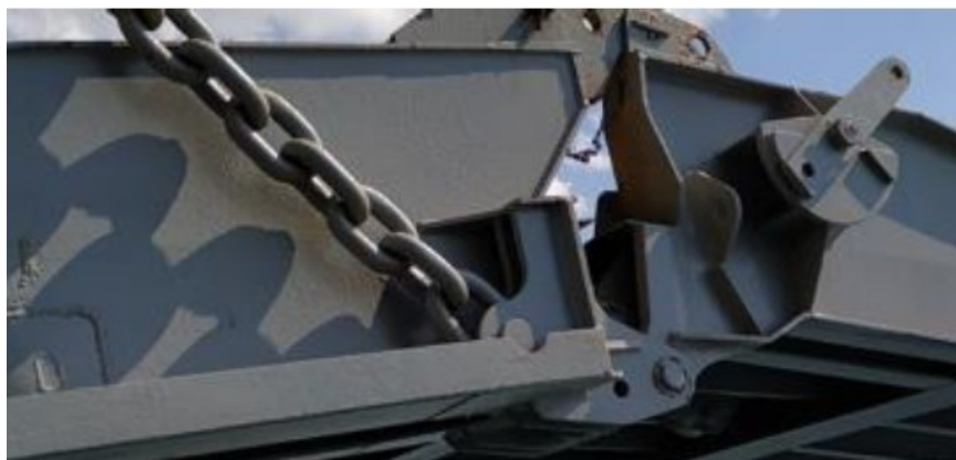
Εικόνα 10: Διάταξη συγκράτησης αλυσίδας στον καταπέλτη (clevis brackets)
